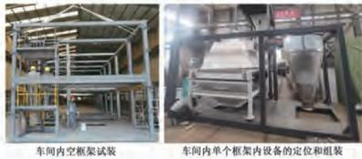
图3: 车间内框架试装和车间内单个框架内设备的定位和组装的现场照片。
