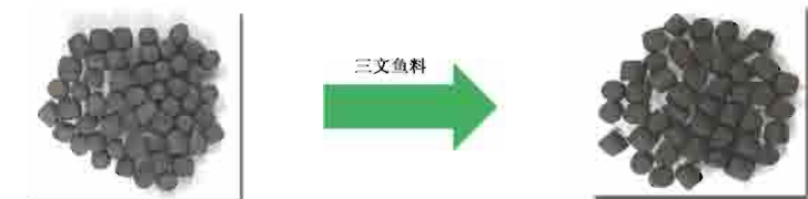
喷涂前 物料容量520 g/L 喷涂后 豆粕12.2% 鱼油10.5% 真空度100Bar
