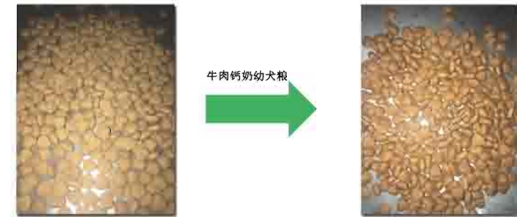
喷涂前 喷涂后 犬用诱食剂5% 油煎10% 犬用粉2% 牛肉香精（油煎）0.27% 真空度100Bar
